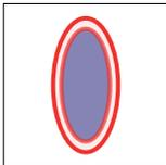
Gefahrenzone Fahrer- und Beifahrerairbag. Fahrer- und Beifahrerairbags, die **rot** umrandet sind, weisen auf zweistufige Airbags hin, bei denen eine Stufe nach Auslösung des Airbags aktiv bleiben kann. Es weist auch auf einen mechanischen Fahrer-Airbag hin, der mittels mechanischer Kraft aktiviert werden kann.
