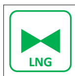
Automatisches Überdruckventil (LNG)
